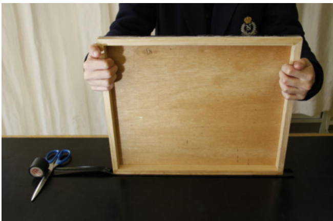
パネルテープをパネルの縁に貼る。その際、パネルテープは水を含ませたスポンジを使ってあらかじめ濡らし、糊が効く状態にしておく。
